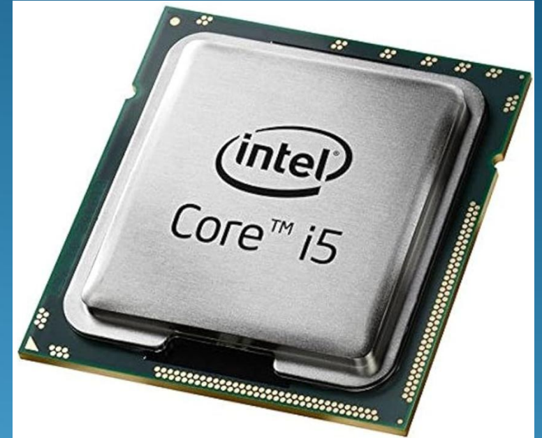
Un circuit intégré dans son enveloppe protectrice
