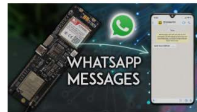
ESP32 : envoyer des messages à WhatsApp à l'aide de la carte SIM – LILYGO T-SIM7000G
